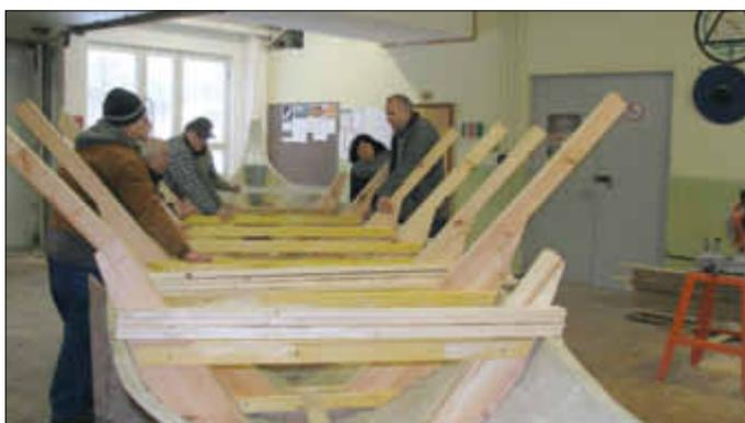
Die Teilnehmer haben alle notwendigen Tätigkeiten zum Bau dieses Bootes selbst ausgeführt. So wurde der Bootsrumf des 9,60 Meter langen Bootes in einer Form in zwei Hälften laminiert, zusammengebaut und der komplette Innenausbau des Bootes aus Holz durchgeführt. Derzeit geht es um die Ruderanlage, den Einbau des Mastes, sowie die Takelage und das Segel.
